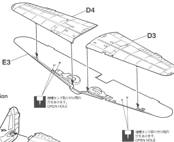
**6** 主翼と水平尾翼の取り付け
