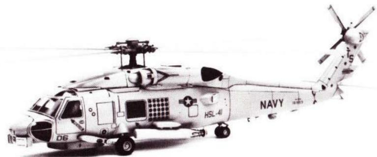
シコルスキー SH-60Bシーホークは米海軍のLAMP Mk.3 (第3次多目的軽航空機システム)に採用された多目的ヘリコプターです。陸軍のUH-60Aブラックホークを基に艦載機として開発されたもので、エンジンの出力アップ、ローターブレード等の折りたたみ機構、ホイールベースの短縮などの改修が施され、艦載機として必要な装備や電子機器が搭載されています。ASW(対潜水艦戦)やASST(対艦船索敵)を主任務とし、捜索救難、各種輸送などに活躍しています。シーホーク最初の飛行隊はHSL-41で1984年に編成されました。
