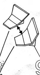
Die 3-teilige Bodenplatte mit Contacta Liquid Spezial aneinanderkleben !
