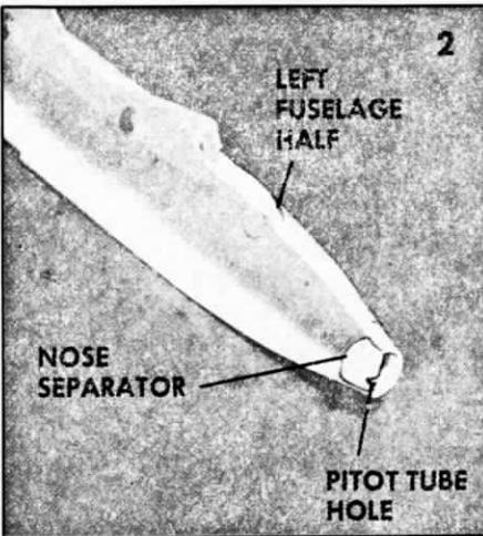
Collez la cloison du nez dans la moitié gauche du fuselage comme indiqué. Notez que le trou de la sonde anémométrique est en bas.
