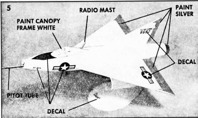
Collez la sonde anémométrique à la cloison du nez. Collez le mât radio à sa place. Posez les décalcomanies comme indiqué ici et dans le paragraphe 6. Peignez les bords de fuite, les surfaces de commande et la tuyère en argenté. Le cadre de l'habitacle est peint en blanc.
