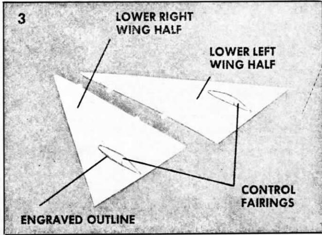
Collez les carénages des commandes aux moitiés inférieures des ailes à l'endroit marqué par les lignes de contour, gravées.
