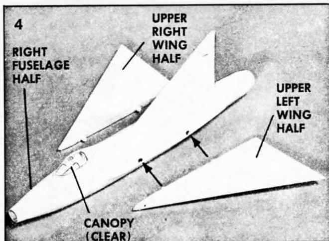
Collez les moitiés du fuselage ensemble. Peignez l'intérieur du cockpit en noir. Le pilote a une combinaison bleu-vert et un casque blanc. Collez ensemble les moitiés supérieures et inférieures des ailes, puis collez-les au fuselage comme indiqué. Collez l'habitacle au fuselage.
