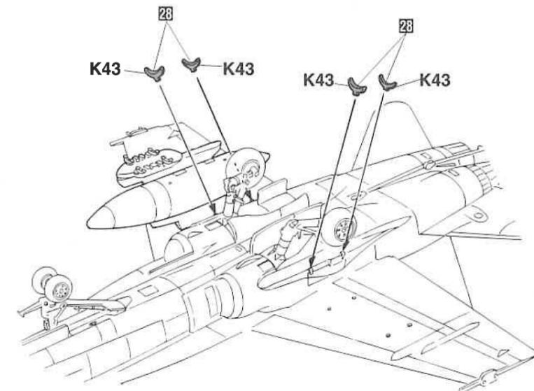
**17** 最終の組み立て Final Assembly
