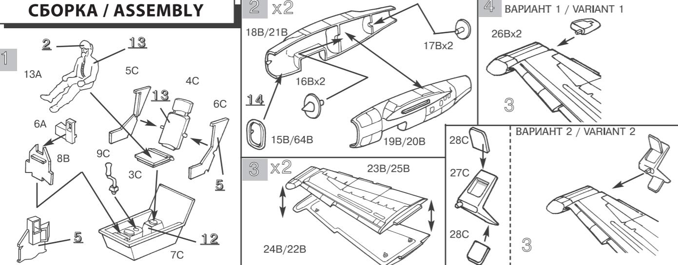
5 В носовую часть фюзеляжа для обеспечения устойчивости модели надо положить груз (можно пластилин) весом не менее 7 грамм.
